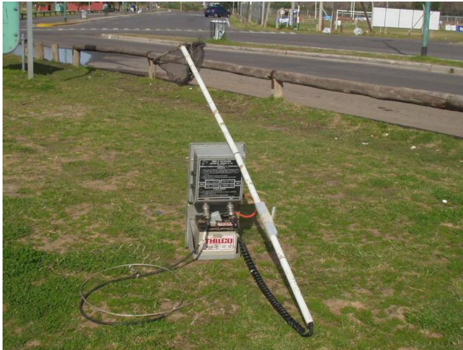
Foto 1. Equipo Smith-Root M12 portátil utilizado para la pesca experimental en zonas litorales y someras del río
